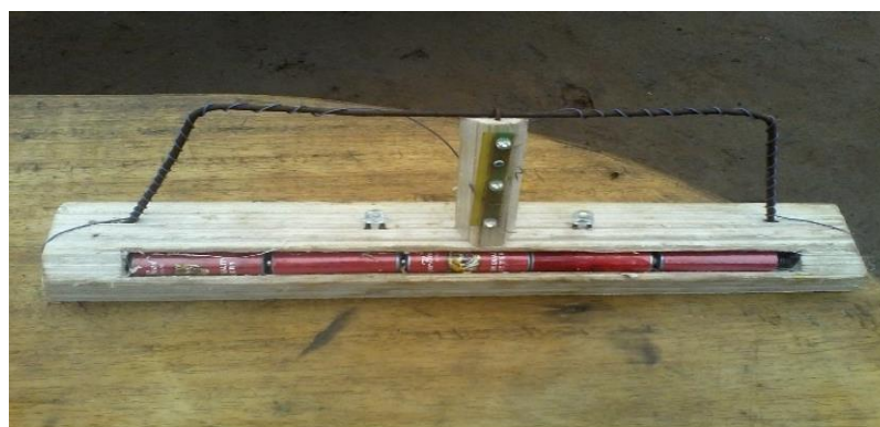
Photo 1 : "Branchement" utilisant des piles AAA et des LEDs
